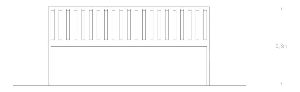
ESTRUCTURA PRINCIPAL: Perfil 70x30x3mm norma ASTM A500
