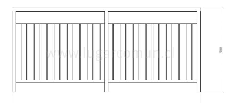
ESTRUCTURA PRINCIPAL: Perfil 40x40x3mm norma ASTM A500
